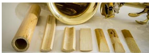
Les différentes étapes de fabrication d'une anche
